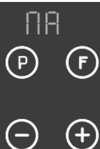
Om terug te keren in de handmatige modus drukt op de knoppen „-“ lub „+“, totdat op de programmaweergave **MA** verschijnt. Bevestig dit met een druk op de programmainstelknop **P** of wacht 15 seconden.
