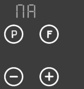
Pour revenir en mode manuel, appuyer sur les boutons « - » ou « + », jusqu'à ce que l'indicateur de programmes affiche **MA**. Pour confirmer, appuyer sur le bouton de programmes **P** ou attendre 15 secondes.
