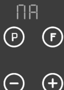
Um in den manuellen Betrieb zurückzukommen drücken Sie die Tasten „-“ oder „+“, bis **MA** in der Programm-Anzeige erscheint. Bestätigen Sie mit der Programm-Taste **P** oder warten Sie 15 Sekunden.
