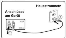
Schließen Sie das eine Ende des AC Netzkabels an den AC-Anschluss des Gerätes ① und das andere
