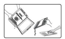
Reinigen Sie das Gerät innen und außen mit einem feuchten Tuch. Verwenden Sie bei starken Verschmutzungen ein mildes Reinigungsmittel.
