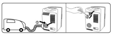
Staub oder andere Verunreinigungen am Ventilator beeinträchtigen die Kühl- oder Wärmeleistung. Reinigen Sie den Ventilator regelmäßig. Verunreinigungen im Lufteintritts- und Luftaustrittsbereich können Sie mit einem Staubsauger absaugen oder mit einer Staubbürste beseitigen (Abb. ① + ②).
